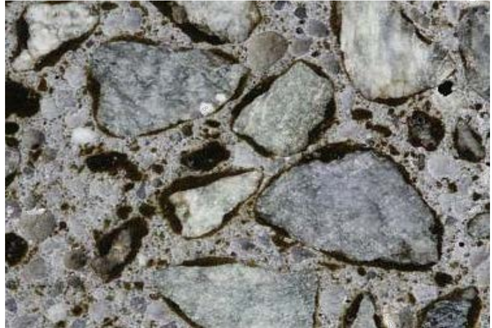
Tynnslip av MC Pot Hole Repair materialet etter herding. Den sorte hinnen rundt tilslagene er bitumen.
